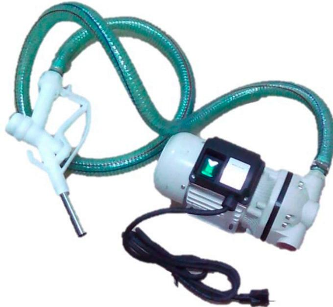
Bomba tipo diafragma eléctrica 12V, conexión de succión y descarga de 1", cuerpo en polipropileno y diafragmas en teflon, despacho 10GPM, presión de descarga 40psi, ciclo de trabajo máximo 30 minutos. Incluye mangueras y pistola. Especial para trasiego de productos corrosivos, urea, tintas, pinturas, farmacos, solventes, alcoholes, salsas y líquidos de viscosidad media. Marca "ARCO".
